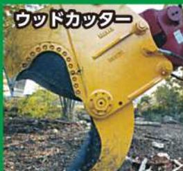
ウッドカッター 樹木の根株、枝葉の 切断、除去
