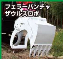
フェラーパンチャ ザウルスロボ 樹木伐採(直径40cm) 掴む・運ぶ等
